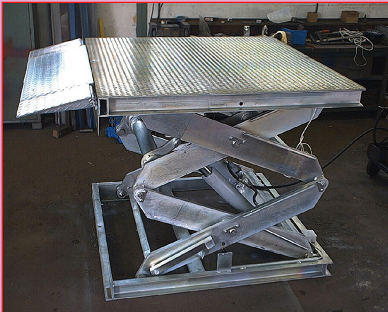
Dvina miza v pocinkani izvedbi, montirana v agresivnem okolju (kemina tovarna)
